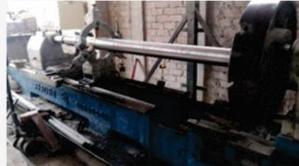
3 Mecanizado de Contra Eje de Molino Denver 6ft x 8ft.
